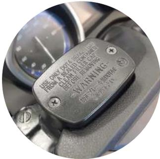
Attenzione! Il fluido freni può danneggiare seriamente il vostro veicolo. Riparare le parti esposte durante le operazioni di smontaggio. Rimuovere il Tappo originale.
