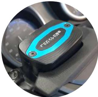
Montare il tappo Reckless come mostrato nello schema. Utilizzare le viti fornite nella confezione. Il tappo Reckless è progettato per essere montato con la guarnizione ed il diaframma originali. Una guarnizione usurata o un montaggio inadeguato possono mettere a rischio la sicurezza della frenata. Per un'installazione sicura del componente rivolgetevi ad un'officina specializzata.
